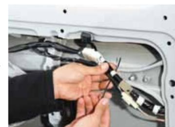
付属の純正カブラー変換ケーブルと車両側カブラーを接続します。
